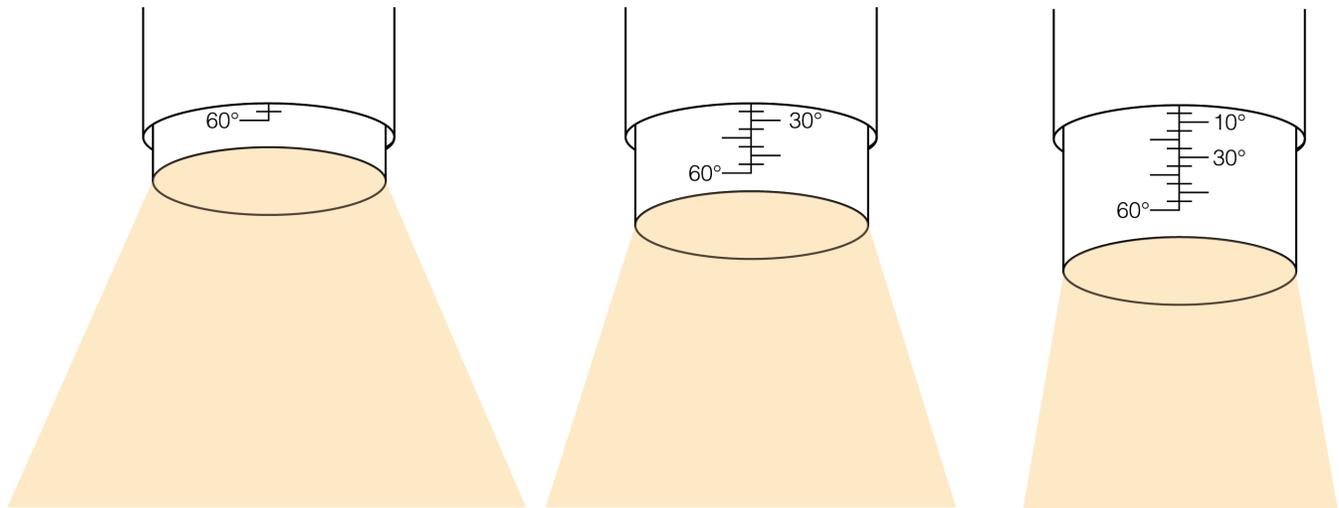
Toute la famille Zoombar a un angle de faisceau réglable sur le terrain. Il peut être ajusté en tirant le canon vers l'extérieur ou en le poussant à l'intérieur luminaire. Des marquages discrets sur le côté du canon sont présents pour aider à sélectionner le faisceau souhaité.
