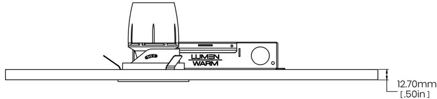
Pour un maintien optimal, l'épaisseur du gypse doit être de 5/8".
