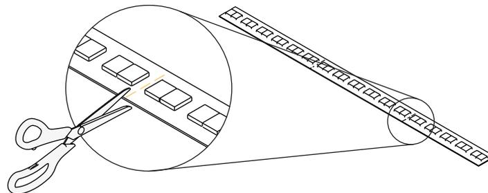
*i* Si plusieurs *Extrusions* sont installées bout à bout sans embouts entre les deux, coupez le *Ruban LED* pour couvrir la longueur **totale** de ces *Extrusions*.
