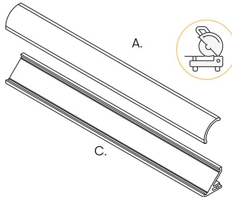
*i* Couper les deux pièces ensemble en même temps garantit un résultat optimal. Pour ce faire, utilisez une lame en carbure métallique de 80 dents ou plus.
